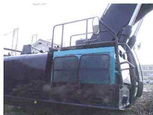
リフマグ用電源架装状況
